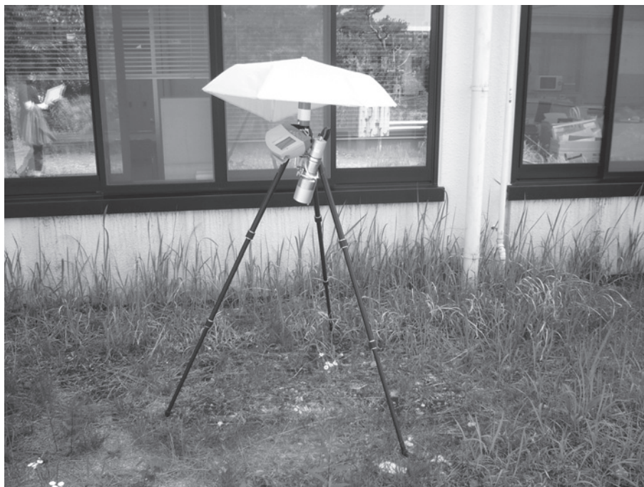
図1：名古屋大学東山キャンパス内#3地点で測定中の様子。画面中央の円筒形の部分がNaI放射線検出器（センサー）で、センサー下の半径2～3mの地面や、壁があれば側面からの放射線（ \gamma 線）が測定される。ケーブルで繋がっている左直上の箱がデータ収録・解析装置。淡青色の日傘は、日よけ用である。
