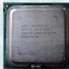
比較的最近のCPU : Intel Xeon 5040 (サンプル品)
