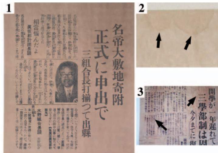
図6 液剤の吹き付け・“焼き”の段階での失敗例。1 焼き時間が長く、焦げ付いた例。2 高濃度液剤が原因の色ムラ(矢印部分)。3 焼いている途中、こまめに位置を変えなかったために生じた焼きムラ。リング状の濃色部(矢印部分)は、オープンの天板に長時間、直に触れていた部分。
