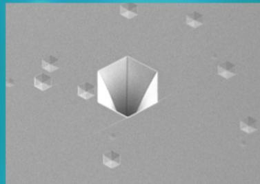
GaN結晶 欠陥評価法(エッチピット法)電子顕微鏡画像
